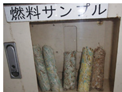
紙系廃棄物を固形燃料にした燃料サンプル
