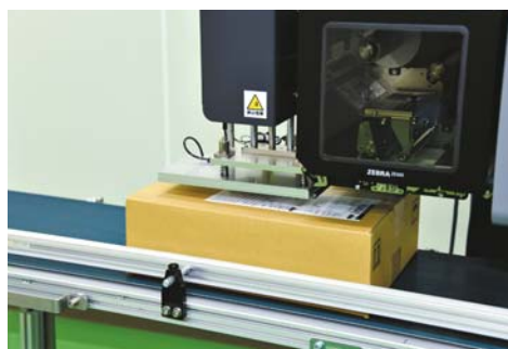
コンベヤーで搬送される荷物にラベリングマシンで宛名ラベルを発行・貼付
