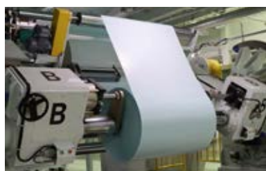
無溶剤型剥離紙用の塗工設備(熊谷工場)
