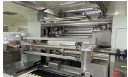
吾妻工場に新設した新型塗工機
