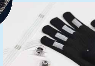
糸状にしたカーボンナノチューブをグローブに編み込み、センサーとして活用
