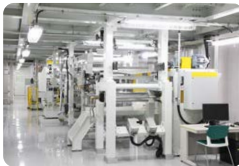
大型テスト塗工設備
