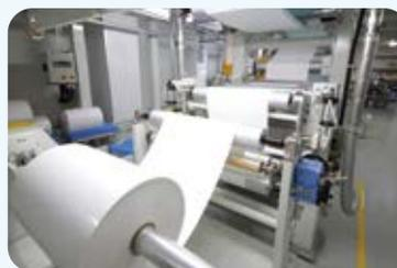
研究所の先端技術棟に導入された大型テスト塗工設備
