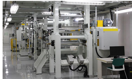
量産化テスト塗工設備
