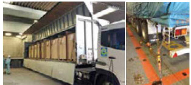
ในการป้องกันไม่ให้สินค้าล้มจากกอง เราได้ยึดสินค้าที่อยู่ในห้องสินค้าของรถบรรทุก (รูปด้านซ้าย) และยึดรถบรรทุกไว้ในห้องโดยสารเรือด้วย (รูปด้านขวา)
