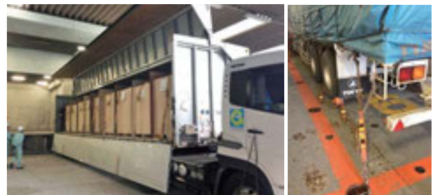
Menetapkan pemuatan barangan dalam trak "gambar kiri" dan juga menetapkan trak di dalam kapal "gambar kanan" untuk mencegah runtuhnya bebanan
