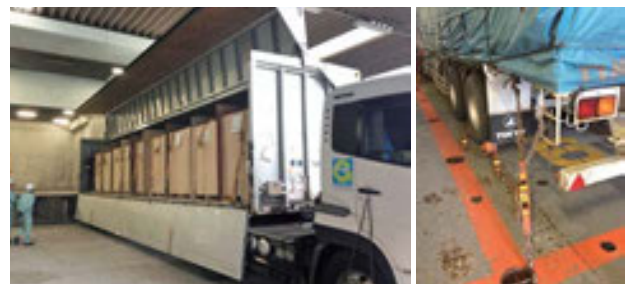
為了防止貨物散落，將卡車上的貨物固定好(左邊照片)，並將船內的卡車也固定住(右邊照片)
