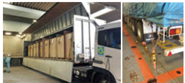
荷崩れを防ぐため、トラック荷台内で積載品を固定【写真左】するとともに、船内においてもトラックを固定【写真右】
