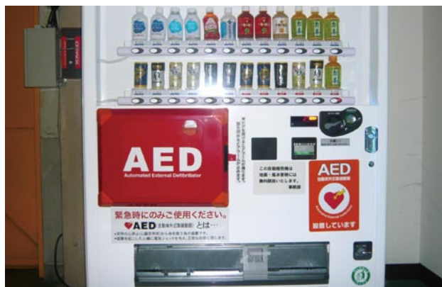
吾妻工場に設置した災害救援ベンダー
