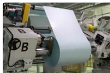
無溶剤型剥離紙用の塗工設備(熊谷工場)
