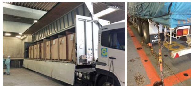
화물 봉고를 예방하기 위해 트럭 화물칸에 적재된 물건을 고정[사진 왼쪽]하고, 화물선 내에서도 트럭을 고정[사진 오른쪽]
