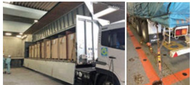
Untuk mencegah produk jatuh, produk dipaskan di bagian dalam truk (gambar kiri), begitu juga di kapal, truk diletakkan dengan pas (gambar kanan)
