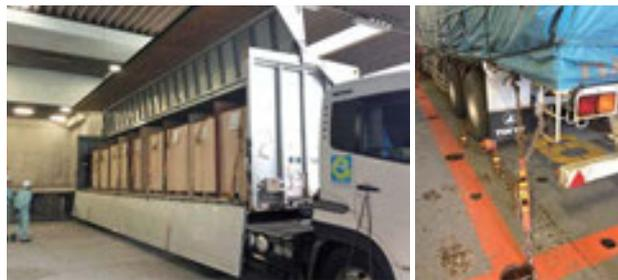
为了防止货物散包，将装载货物固定在卡车货架上【左图】，同时，也将卡车固定在船上【右图】
