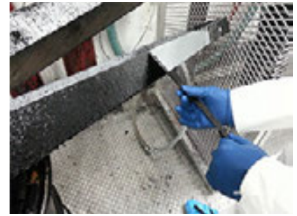
塗工設備に特殊加工を施し、残留塗工液を剥がせるよう改善
