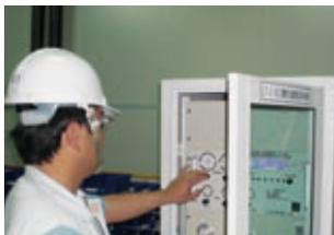
Alat pengukur VOC otomatis
